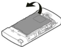
Rimozione sicura. Spegnerne sempre il dispositivo e scollegare il caricabatterie prima di rimuovere la batteria.
