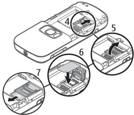
Schließen Sie die Halterung der SIM-Karte und schieben Sie sie in Pfeilrichtung, bis sie einrastet (7).
