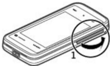
2. Insérez une carte SIM compatible dans l'emplacement pour carte SIM. Assurez-vous que la zone de contact sur la carte est orientée vers le bas et que le coin biseauté fait face à l'appareil. Insérez la carte.
