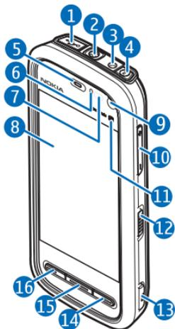
1 — Conector Micro USB para conectarse a un ordenador compatible
