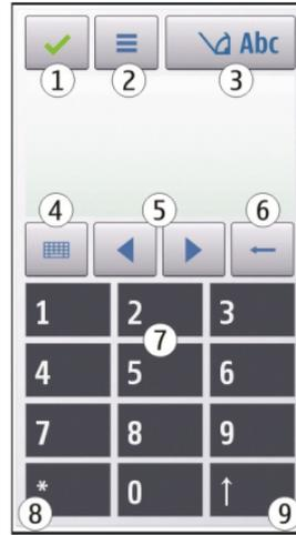
١ - إغلاق - لإغلاق لوحة مفاتيح الشاشة (لوحة المفاتيح الأبيدية الرقمية).
