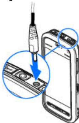
3. Wenn der Akku vollständig geladen ist, steigt die Ladekontrollanzeige nicht mehr an. Trennen Sie das Ladegerät erst vom Gerät und dann von der Netzsteckdose.
