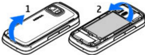
rückseitige Cover ab, indem Sie es an der unteren Seite des Geräts ansetzen.
