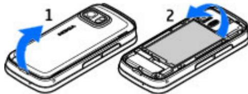
levantando-a, começando pela parte inferior do dispositivo.
