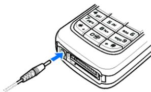
Il tempo di carica dipende dal tipo di caricabatterie e di batteria utilizzati. Ad esempio, la carica di una batteria mediante il caricabatterie ACP-12 richiede circa 1 ora e 20 minuti con il telefono cellulare in modalità di attesa.
