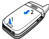
Extraiga la batería tal y como se muestra (3). Abra el compartimento de la tarjeta SIM (4).
