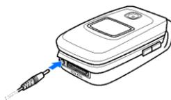
Die Ladezeit hängt vom verwendeten Ladegerät und dem Akku ab. Das Laden des Akkus BL-4C mit dem Ladegerät AC-3 beispielsweise dauert etwa 2 Stunden und 12 Minuten, wenn sich das Telefon in der Ausgangsanzeige befindet.
