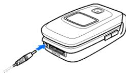
Le temps de charge dépend du chargeur et de la batterie utilisés. Par exemple, en mode veille il faut environ 2 heures 12 minutes pour charger une batterie BL-4C avec un chargeur AC-3.
