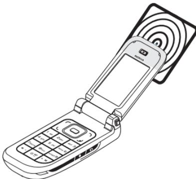
Il raggio di lettura normalmente va da 0 a 3 centimetri.
