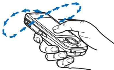
Se o círculo for apresentado a amarelo, a calibração apresenta pouca precisão e deverá continuar a rodar o dispositivo. Quando a bússola estiver activada e o círculo em redor da bússola for apresentado a verde, a vista de mapas é activada
