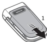
2. Para retirar la batería, levántela del modo en que se muestra.
