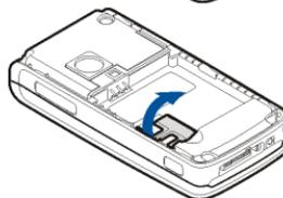
4. Setzen Sie die SIM-Karte in die dafür vorgesehene Führung (4) ein. Stellen Sie sicher, dass die SIM-Karte richtig eingelegt ist und die Seite mit den Goldkontakten nach unten zeigt. Schließen Sie den SIM-Kartenhalter und drücken Sie ihn, bis er einrastet.
