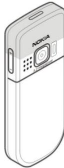
Устройство может быть оснащено внутренними и внешними антеннами. Не следует без необходимости прикасаться к антенне во время передачи или приема. Прикосновение к антеннам ухудшает качество связи, может привести к нецелесообразному увеличению мощности излучаемого сигнала и сокращению времени работы аккумулятора.
