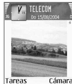
*Fig. 1 Modo en espera con una nueva imagen de fondo, un nuevo acceso directo a la tecla de selección, y con red UMTS y Bluetooth activado.*
