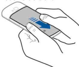
2. Schieben Sie die SIM-Karte in den SIM-Kartenhalter ein. Vor dem Einsetzen der SIM-Karte muss der Akku entfernt werden.
