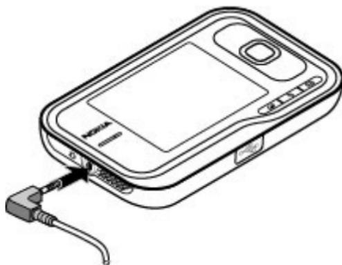
Non collegare prodotti che generano segnali in uscita, in quanto ciò potrebbe danneggiare il dispositivo. Non collegare il Nokia AV Connector ad alcuna fonte di alimentazione.
