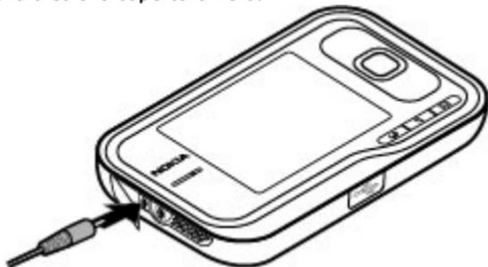
3. Quando la batteria è completamente carica, scollegare il caricabatterie dal dispositivo, quindi dalla presa a muro.
