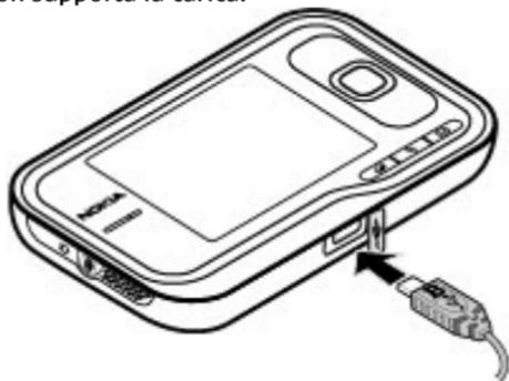
Per evitare di danneggiare i dati, non disconnettere il cavo dati USB durante il trasferimento dati.
