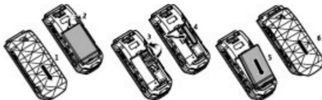
1. Para remover a tampa, prima e deslize a tampa posterior na direcção da parte inferior do telefone (1).
