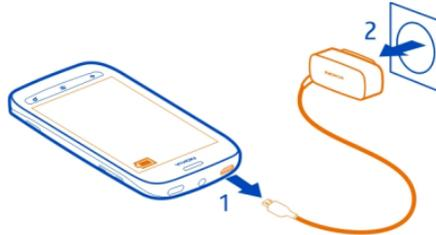
Gehen Sie beim Anschließen und Abziehen des Ladekabels vorsichtig vor, um den Ladegeräteanschluss nicht zu beschädigen.
