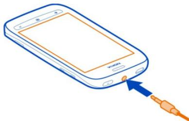
Nemojte spajati proizvode koji stvaraju izlazni signal jer to može uzrokovati oštećenje uređaja. Nemojte spajati naponske izvore u audiopriključnicu. Ako na audiopriključnicu spojite vanjski uređaj ili slušalicu koje nije odobrila tvrtka Nokia za upotrebu s ovim uređajem, posebnu pozornost obratite na razine glasnoće.
