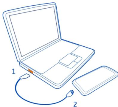
2 Kada je baterija puna, prvo isključite USB kabel iz telefona, a zatim iz računala.
