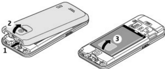
posteriore e rimuoverla. Rimuovere la batteria per sbloccare il supporto della carta SIM.
