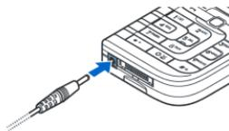
Si el teléfono está encendido, aparece brevemente el texto *Cargando*. Si la batería está completamente descargada, pueden pasar varios minutos hasta que aparezca en pantalla el indicador de carga o hasta que se pueda realizar una llamada.
