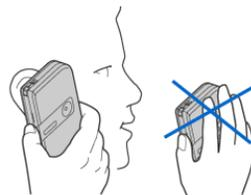
une puissance plus élevée que nécessaire. Eviter de toucher l'antenne pendant le fonctionnement de l'appareil optimise les performances de l'antenne ainsi que la durée de vie de la batterie.
