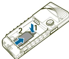
3. Remplacez la batterie. Vérifiez le bon positionnement des connecteurs de la batterie
