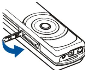
Um das SIM-Fach zu verriegeln, schieben Sie die Abdeckung des SIM-Fachs nach rechts.
