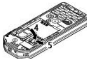
5. Inserire la batteria e montare il cover posteriore del dispositivo.
