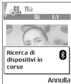
Fig. 24 Invio di una foto tramite Bluetooth. Il telefono cellulare inizierà a cercare i dispositivi.
