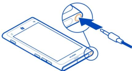
Não ligue produtos que originem um sinal de saída, uma vez que poderá causar danos no dispositivo. Não ligue qualquer fonte de tensão ao conector de áudio. Se ligar um dispositivo externo ou auricular diferentes dos aprovados pela Nokia para utilização com este dispositivo, ao conector de áudio, preste especial atenção aos níveis do volume.
