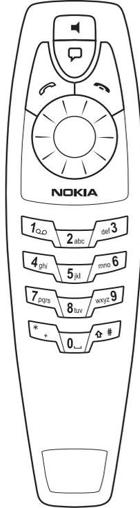
Der Bedienhörer besteht aus einem Funktionsfeld, einem alphanumerischen Eingabefeld, dem Mikrofon und dem Hörer.
