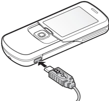
Ο χρόνος φόρτισης εξαρτάται από τον φορτιστή που χρησιμοποιείτε. Η φόρτιση μιας μπαταρίας BP-5M με το φορτιστή AC-6 διαρκεί περίπου 2 ώρες και 15 λεπτά ενώ το τηλέφωνο βρίσκεται σε λειτουργία αναμονής.
