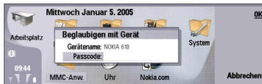
Im nächsten Schritt können Sie wahlweise eine Bluetooth Verbindung vom Funk-Kfz-Einbausatz Nokia 610 akzeptieren oder ablehnen. Wenn Sie diese Verbindung akzeptieren, wechselt das Nokia 9300i in den Remote-SIM-Zugriffsmodus, der durch ein SIM-Symbol angezeigt wird. Dieses Symbol steht neben dem Bluetooth Symbol und einem Symbol, das
