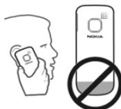
La figura muestra el área de la antena GSM marcada en gris.
