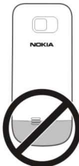
Uredaj može da ima interne i eksterne antene. Izbegavajte nepotrebno dodirivanje antene dok se preko nje odvija prenos ili prijem. Dodirivanje antena utiče na kvalitet radio komunikacija, može da prouzrokuje rad uređaja na višem energetskom nivou i da skrati životni vek baterije.
