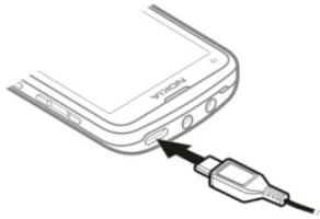
Для начала зарядки по USB требуется более длительное время, и зарядка может не выполняться при подключении к концентратору USB, на который не подается питание. При подключении к сетевой розетке устройство заряжается быстрее.
