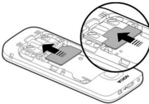
Achten Sie darauf, dass der Kontaktbereich auf der Karte nach unten zum Gerät und die abgeschrägte Ecke der Karte zum Kartensteckplatz weist.
