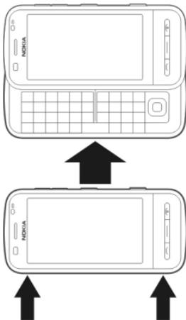
Vaš uređaj ima cijelu tipkovnicu. Da biste otvorili tipkovnicu, povucite dodirni zaslon prema gore. U svim programima zaslon se automatski okreće iz portretnog usmjerenja u pejzažno kada otvorite tipkovnicu.
