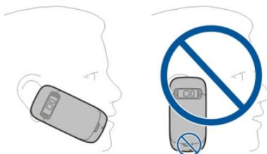
Za najbolje poništavanje šuma držite uređaj sa slušalicom u uhu i glavni mikrofon prema ustima. Nemojte pokrivati pomoćni mikrofon na pozadini uređaja.
