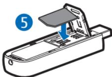
5. Faites pivoter le logement pour le remettre en place et faites-le glisser vers l'œillet pour le fermer (6).
