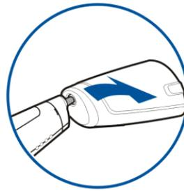
3. Setzen Sie vorsichtig eine neue Kugelschreibermine in den Stift ein, und schieben Sie diese bis zum Anschlag (4). Ersatztintenbehälter erhalten Sie bei Ihrem Händler vor Ort. Verwenden Sie zum Nachfüllen nur Tintenbehälter gemäß ISO 12757-2 DOC.
