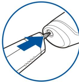
2. Winkeln Sie die Kappe leicht an und ziehen Sie die Mine mit Hilfe der Kappe heraus. Entsorgen Sie die Kugelschreibermine ordnungsgemäß (3).
