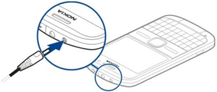
إذا كنت تستخدم جهاز شحن USB، فقم بتوصيل قابس جهاز الشحن بمنفذ توصيل USB.
