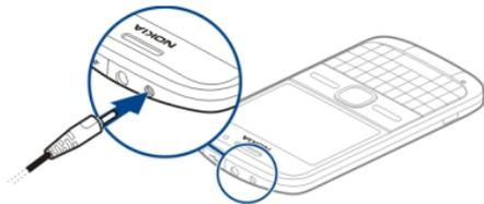
Si utiliza un cargador USB, conecte el enchufe del cargador al conector USB.
