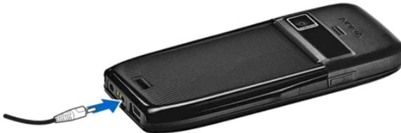
Schließen Sie das Kabel des Ladegeräts an das Gerät an. Wenn der Akku vollkommen leer ist, beginnt die Ladekontrollanzeige möglicherweise erst nach einer kurzen Zeit zu steigen.
