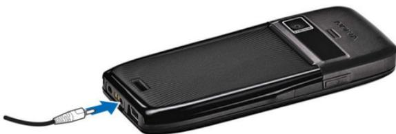
Ligue o cabo de alimentação ao dispositivo. Se a bateria estiver completamente descarregada, pode demorar algum tempo até o indicador de carga começar a deslincar-se.
