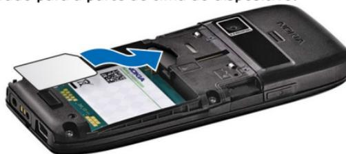
4. Introduza a bateria. Alinhe os contactos da bateria com os conectores correspondentes do compartimento da bateria e insira-a na direcção da seta.
