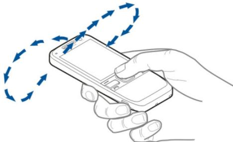
Drehen Sie das Gerät in einer zusammenhängenden Bewegung um alle Achsen, bis die Kalibrierungsanzeige beginnt, grün zu leuchten
