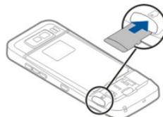
3. Setzen Sie die Speicherkarte in den Steckplatz ein. Achten Sie dabei darauf, dass Sie die Seite mit den Kontakten zuerst in den Schlitz schieben. Achten Sie darauf, dass der Bereich mit den goldfarbenen Kontakten in Richtung der Kontakte des Geräts zeigt.
