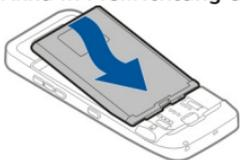
5. Um das rückseitige Cover wieder anzubringen, führen Sie die oberen Arretierungen in die entsprechenden Führungen, und drücken Sie das Cover dann nach unten, bis es einrastet.
