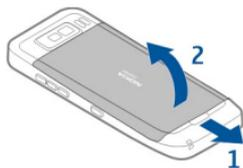
2. Si la batterie est en place, faites-la sortir de son logement dans la direction indiquée par la flèche.
