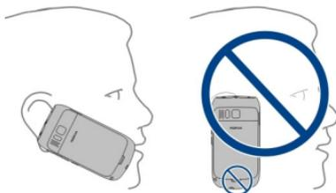
Para conseguir la mejor cancelación de ruido, sujete el teléfono con el auricular en el oído y con el micrófono principal orientado hacia la boca. No tape el micrófono secundario de la parte posterior del teléfono.
