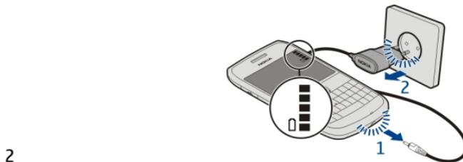
No es necesario cargar la batería durante un período de tiempo específico y puede utilizar el teléfono mientras se carga.
