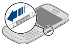
**Sugerencia:** Si el interruptor de bloqueo se encuentra fuera de su alcance, para desbloquear el teléfono, pulse la tecla de desplazamiento y seleccione **Desbloq..**
