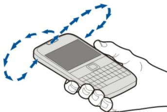
La brújula tiene una precisión limitada. Los campos electromagnéticos, los objetos metálicos u otras circunstancias externas también pueden afectar a la precisión de la brújula. La brújula siempre debería estar perfectamente calibrada.
