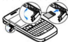
2. Inserte la tarjeta de memoria en la ranura (la zona de contacto primero). Asegúrese de que la zona de contacto esté orientada a los conectores del dispositivo.
