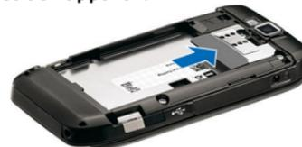
4. Insérez la batterie. Alignez les contacts de la batterie avec les connecteurs correspondants du logement et faites glisser la batterie dans la direction indiquée par la flèche.
