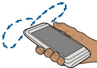
Kompas ima ograničenu preciznost. Elektromagnetna polja, metalni objekti i drugi spoljašnji uslovi takođe mogu da utiču na preciznost kompasa. Kompas treba da je uvek pravilno kalibrisan.
